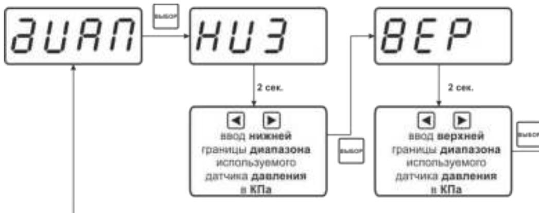
Рисунок 6.8 Схема задания диапазона измерения используемого датчика давления
