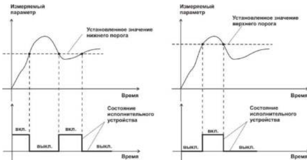
Рисунок 3.14 События: нарушения НП (слева), нарушение ВП (справа)
