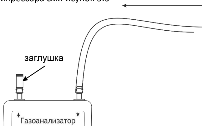
Рисунок 5.3 Непрерывный анализ газа из магистрали (принудительная прокачка)
