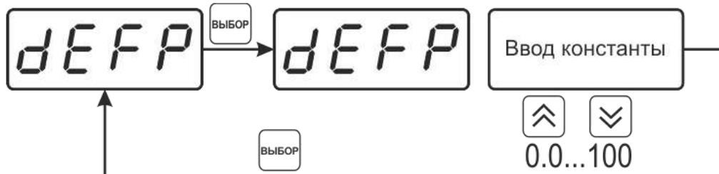
Рисунок 6.30 Введение постоянного параметра регулирования
